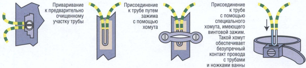
Способы крепления проводников уравнивания потенциалов к металлическим частям ванной
