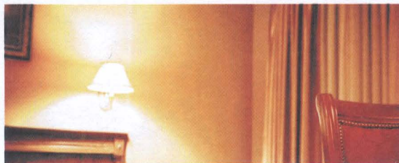
Лампа обеспечивает три типа освещения: направленное вниз, рассеянный свет сбоку и отраженный сверху
