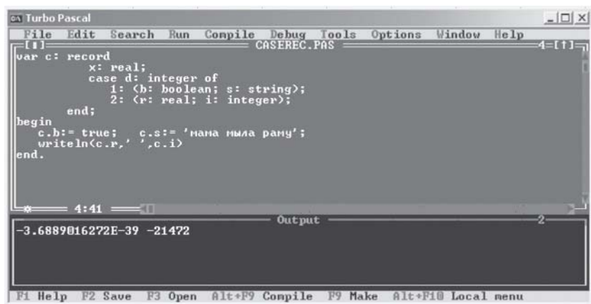
Рис. 9.2. Нарушение типового контроля при обращении к записи с вариантами
