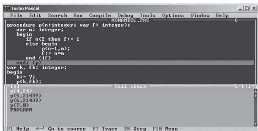
Рис. 17.20. Просмотр списка вызванных подпрограмм с выходными параметрами
