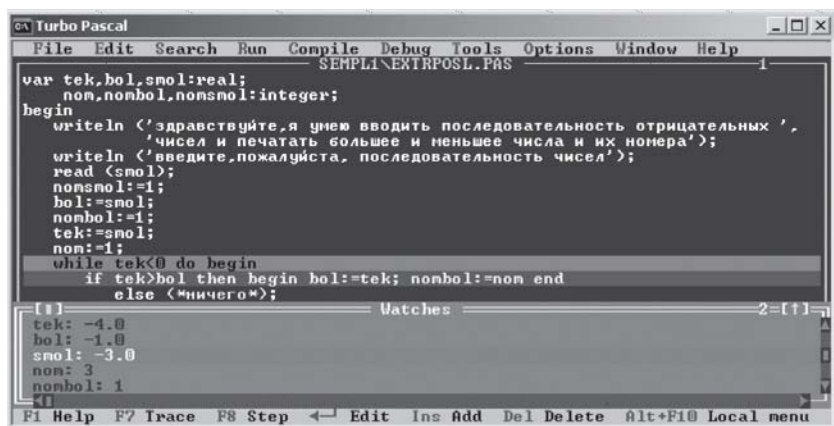
Рис. 17.12. Просмотр значений переменных в окне Watches
