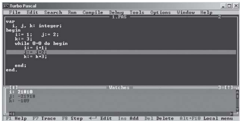
Рис. 17.11. Зацикленная программа, приостановленная с помощью комбинации Ctrl+Break
