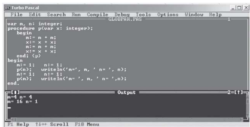
Рис. 9.12. Доступ к одной и той же переменной через параметр, передаваемый по ссылке, и как к глобальной переменной
