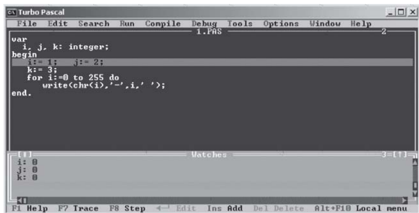
Рис. 17.5. Пошаговое выполнение программы. Состояние до выполнения присваивания значений переменным i и j
