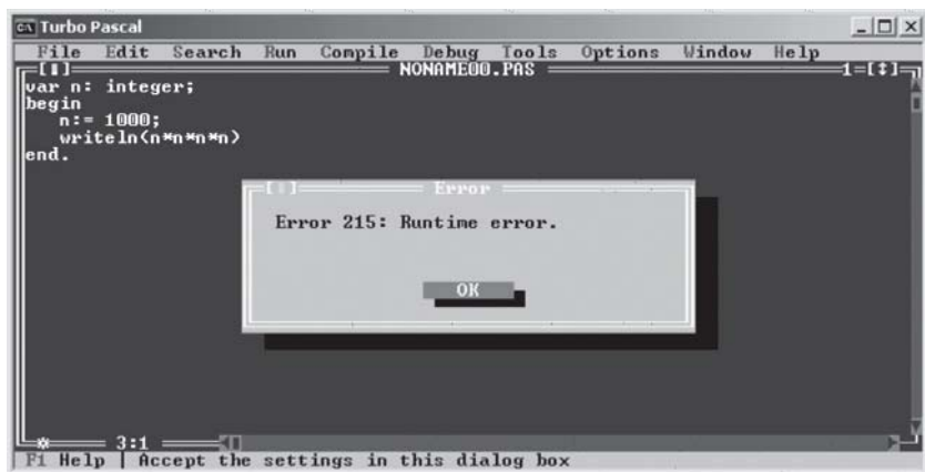
Рис. 17.4. Сообщение об ошибке при отключенных опциях сбора отладочной информации
