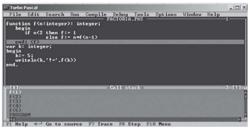
Рис. 17.19. Просмотр списка вызванных в данный момент подпрограмм
