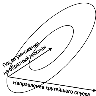
Рис. 3.14. Эффект предварительного умножения направления крутейшего спуска на обратный гессиан
