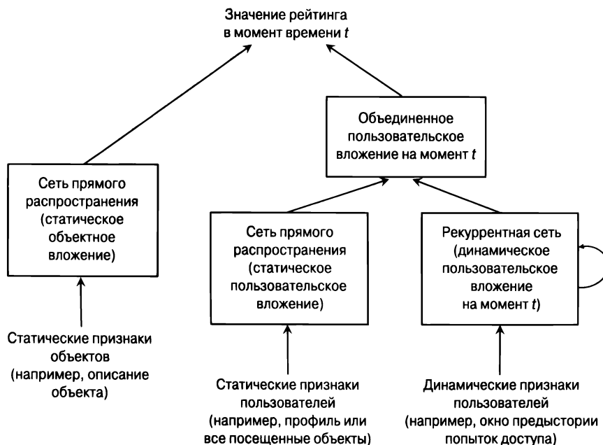
Рис. 7.13. Рекомендательная система на основе рекуррентной нейронной сети. Для каждой отметки времени входом служат статические/динамические признаки пользователей и статические признаки объектов, а рейтинговой оценкой является выход, соответствующий данной комбинации “пользователь — объект”
