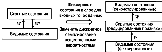
б) Дискретная графическая модель для аппроксимации нейронной сети вещественными значениями
