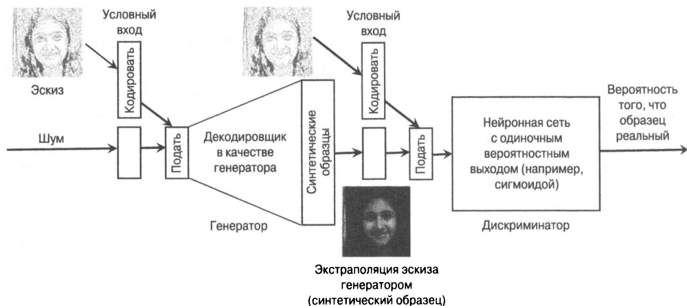
Рис. 10.10. Условная генеративно-сопоставительная сеть для подключенного дискриминатора. Поучительно сравнить эту архитектуру с архитектурой безусловной генеративно-сопоставительной сети, приведенной на рис. 10.7
