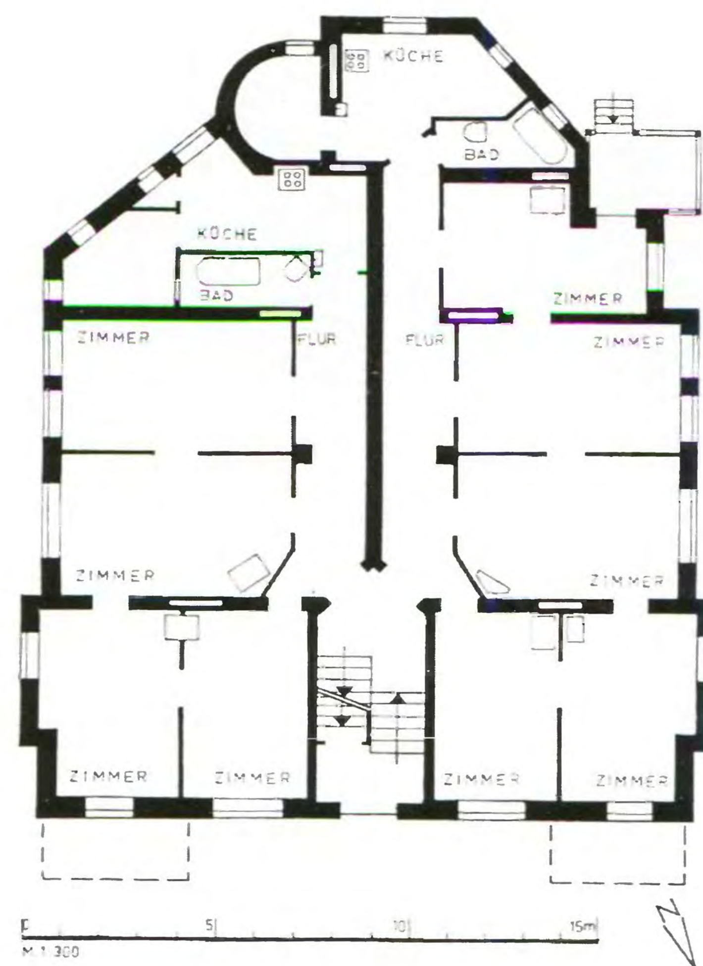
319 План первого этажа в масштабе 1:300. Попытка реконструкции прежнего состояния (по обмерам администрации г. Калининграда в 1981 г. и исследованиям автора)
