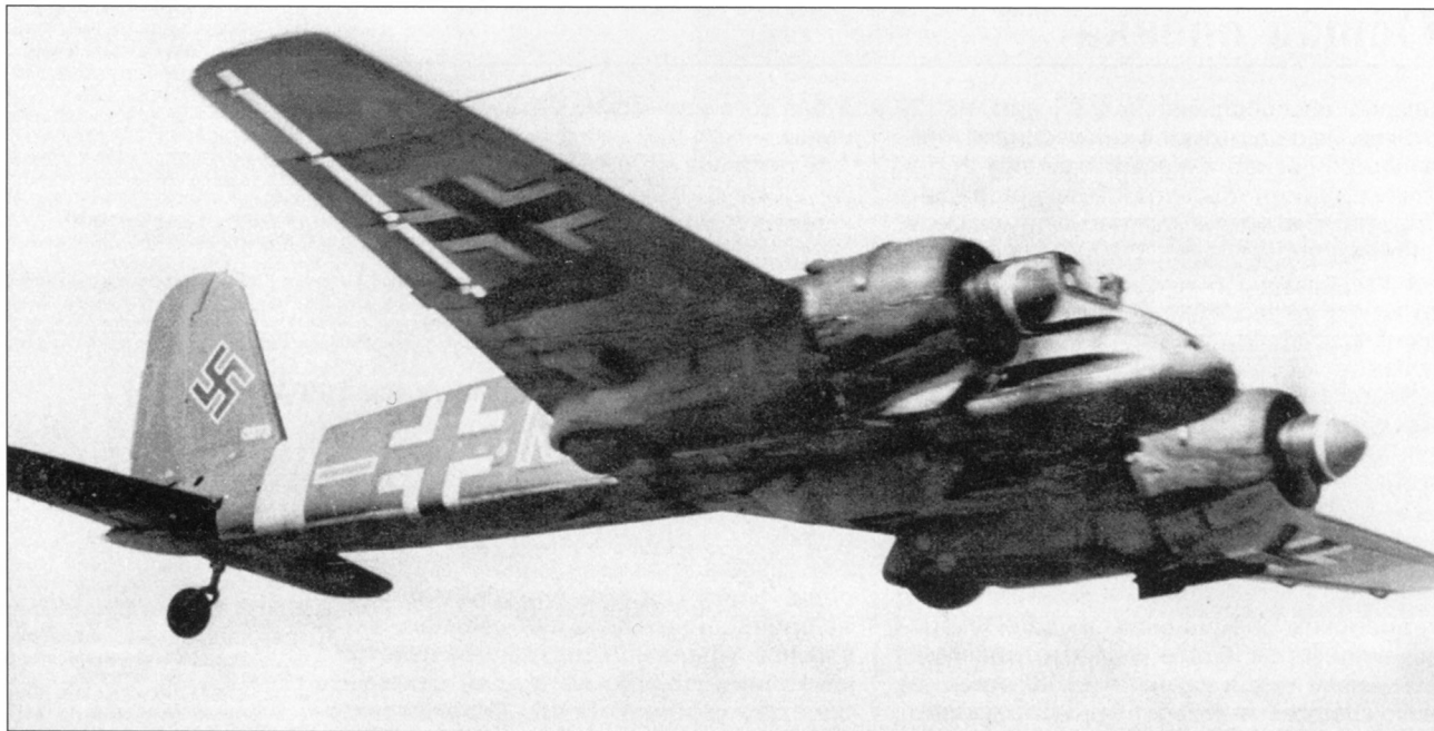
Hs 129B-2 в полете. Самолет вооружен 30-мм пушкой МК 103 в подфюзеляжном обтекателе
