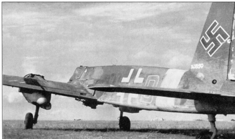
Hs 129B-2 (W.Nr. 141859) готовится к вылету на боевое задание на Восточном фронте. Самолет вооружен 30-мм пушкой MK 103 в подфюзеляжной установке. Хорошо виден наплыв в месте сопряжения крыла и фюзеляжа, где установлена 20-мм пушка MG 151/20
