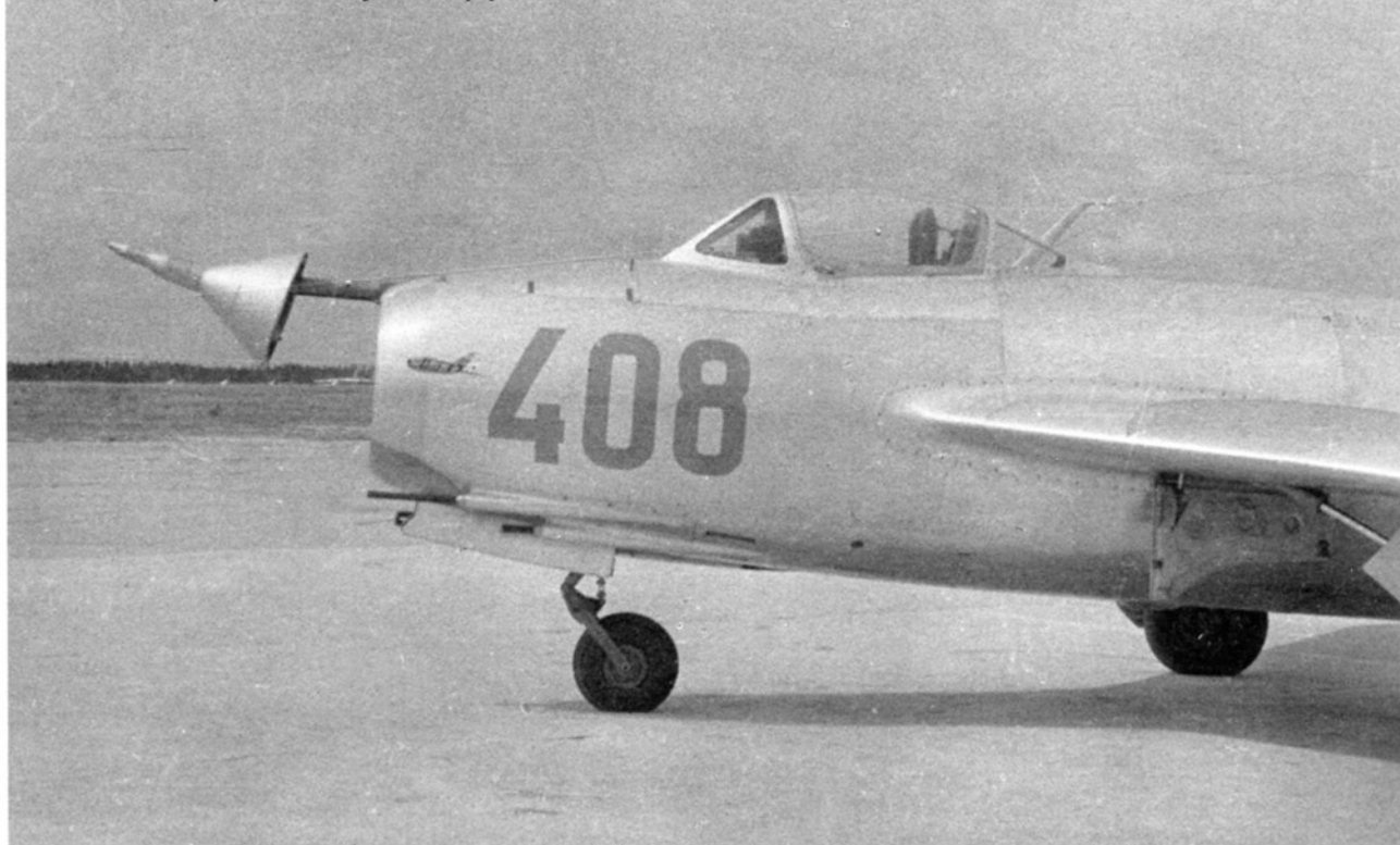
МиГ-15бис с приемником-конусом на гарпуне
