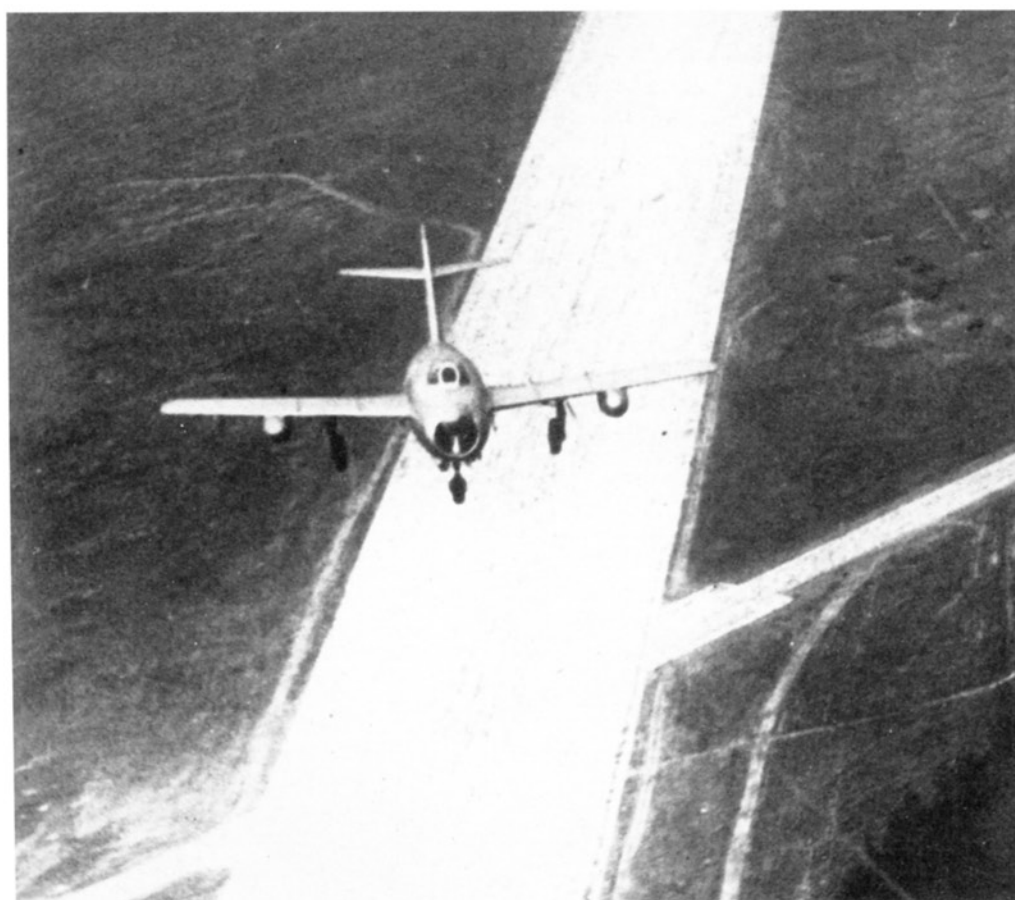
МиГ-15бис в составе аэропоезда
