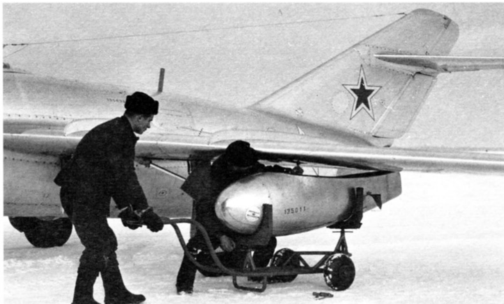
Установка контейнера на самолет
