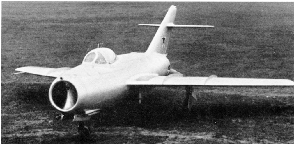
Третий опытный самолет «С-3» с двигателем РД-45Ф
