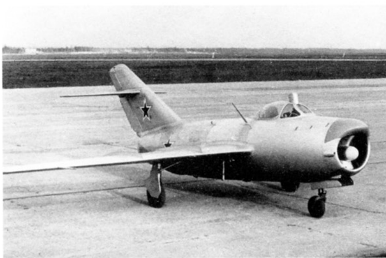
Опытный истребитель-перехватчик «СП-5» с радиолокационным прицелом «Изумруд» и фотопулеметом на козырьке кабины пилота
