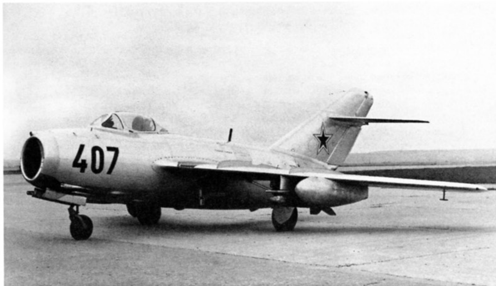
Опытный самолет СД-21 с реактивными орудиями С-21
