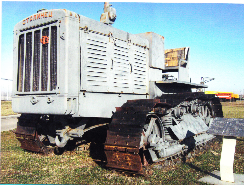
Дизельный мотор, разработанный для трактора С-65, использовали на тягаче С-2.
