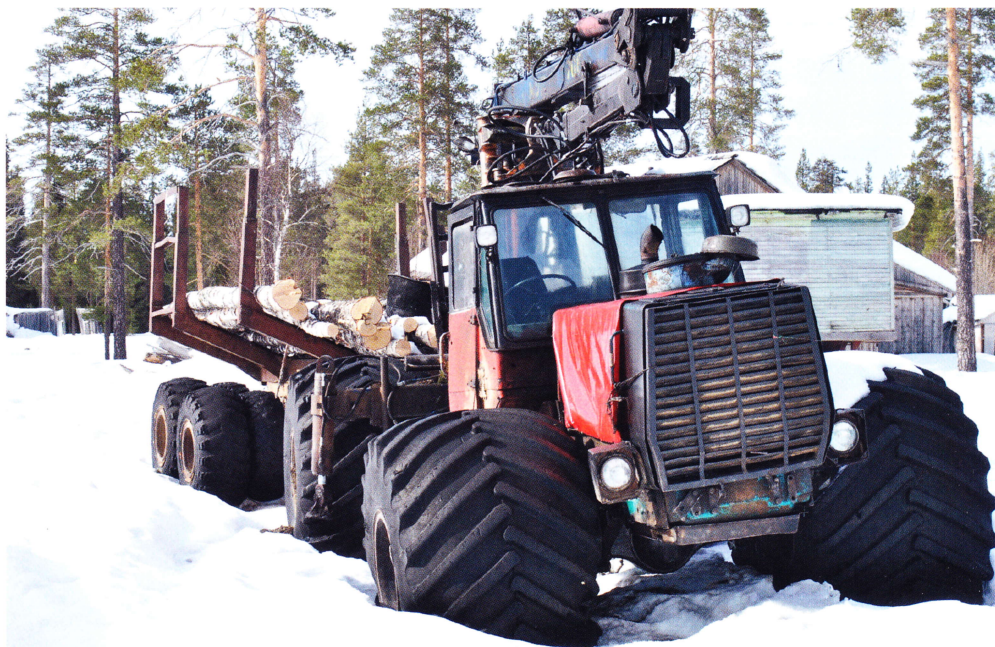
Трактор Т-150 К имеет два ведущих моста.
