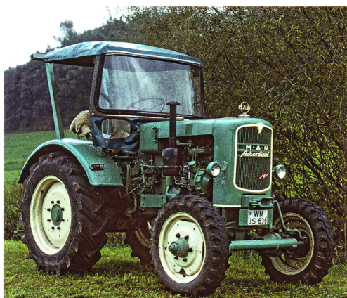
Трактор MAN A 25 A с тентом. Такие аксессуары не входили в стандартную комплектацию, но при желании их можно было приобрести.
