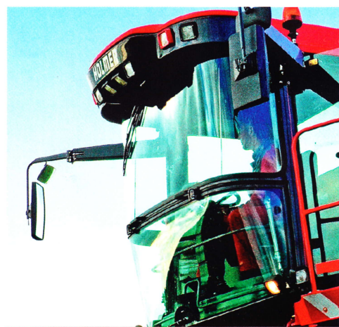
Эргономичная кабина с круговым обзором, звукоизоляцией и автоматической системой климат-контроля.
