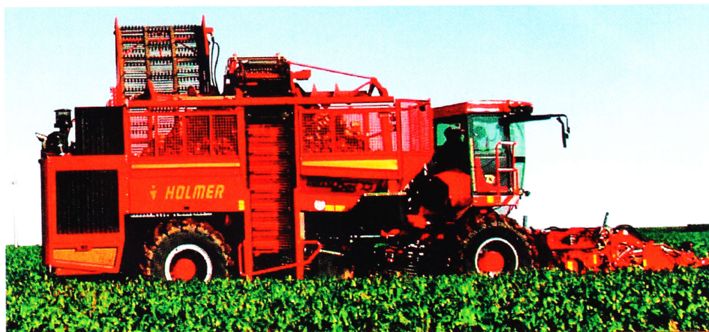
Управление скоростью разгрузочного транспортера производится из кабины.
