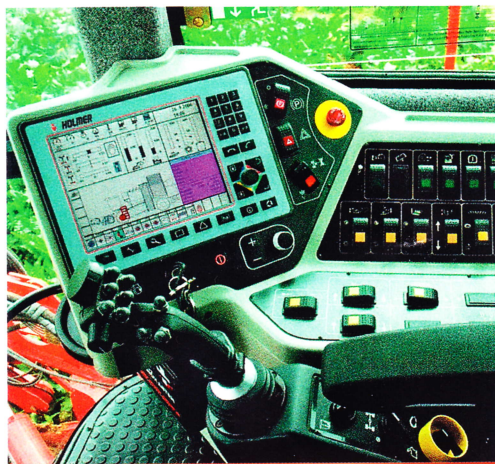
Водитель управляет комбайном из кабины через компьютер при помощи многофункционального джойстика.
