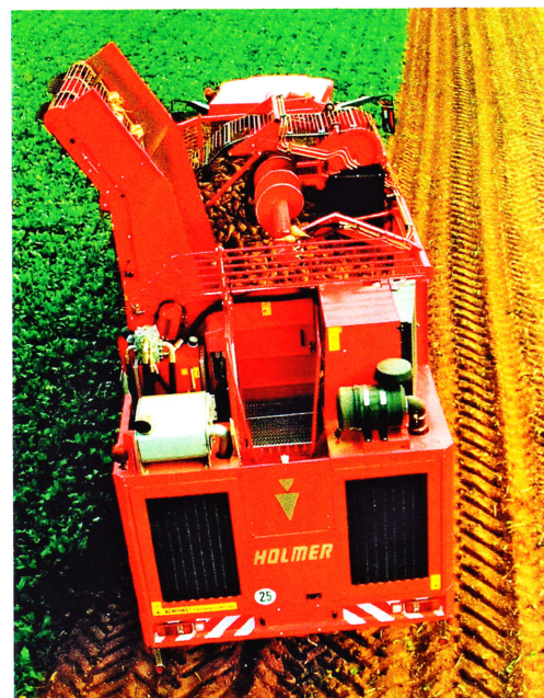
Общий вид бункера, объемом 28 м 3 . Слева: поднятый разгрузочный транспортер, разгружающий бункер в течение нескольких секунд.
