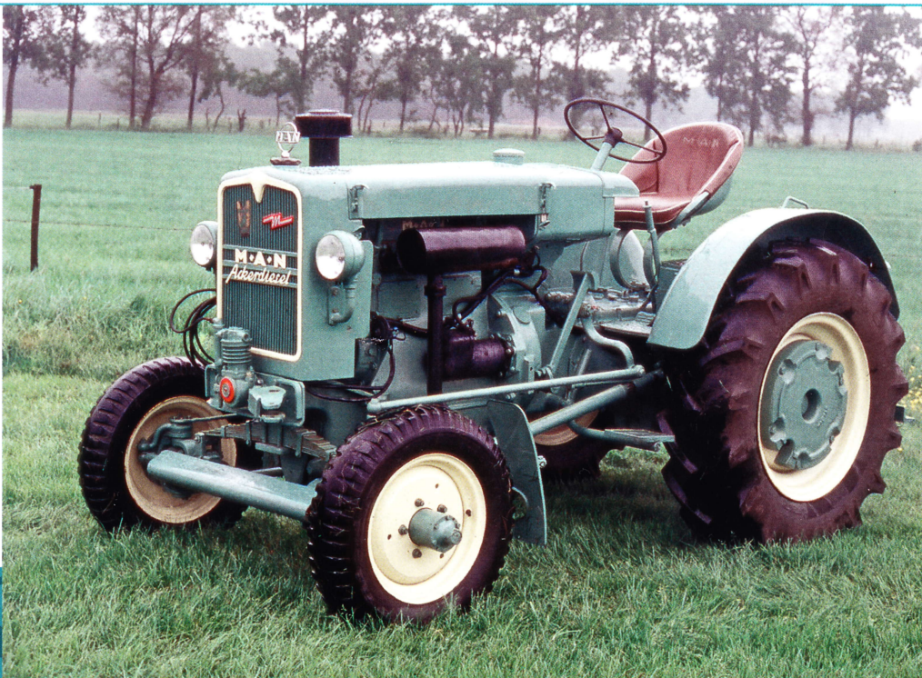
Трактор AN AS 325 A, выпускавшийся с 1949 года в вариантах с полным или задним приводом, можно считать младшим братом модели A 25 A.
