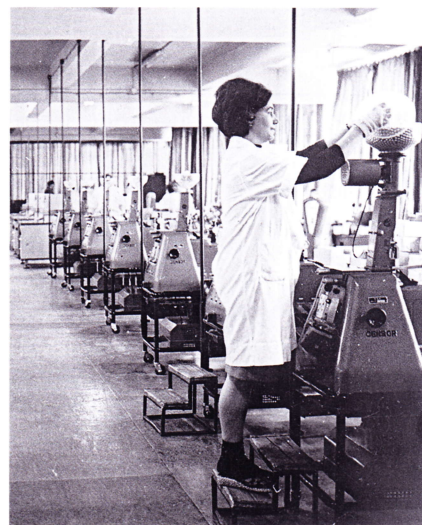
Сортировочные электронные машины на заводе «Рулментул» по производству шарикоподшипников в городе Брашов. 1968 г.
