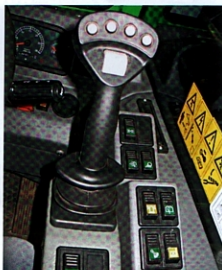
С помощью джойстика водитель может управлять телескопической стрелой с точностью до миллиметра.
