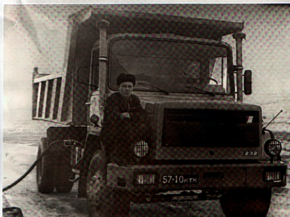
Бамооский вариант Magirus, кроме двух стандартных прямоугольных фар, имел две дополнительные круглые, закрепленные сверху на бампере. Все четыре фары были защищены решетками.
