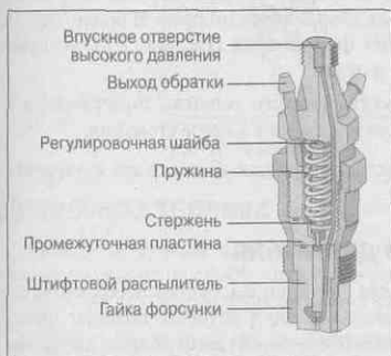
Рис. 7.4. Топливная форсунка в разрезе
