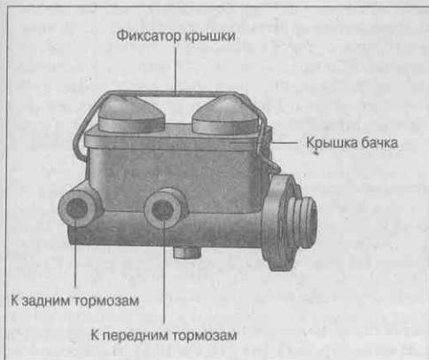
Рис. 10.3. Металлический главный тормозной цилиндр
