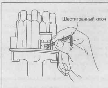
Рис. 12.39. Регулировка контактов прерывателя через регулировочное отверстие
