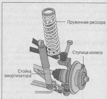
Рис. 11.5. Модифицированная подвеска стоечного типа
