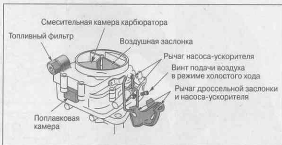
Рис. 13.9. Типичный карбюратор
