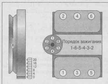
Рис. 12.7. Нумерация цилиндров и порядок зажигания на поперечном V-образном шестицилиндровом двигателе
