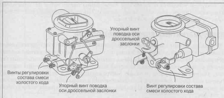
Рис. 6.7. Упорный винт рычага дроссельной заслонки и винт регулировки состава смеси холостого хода на карбюраторе
