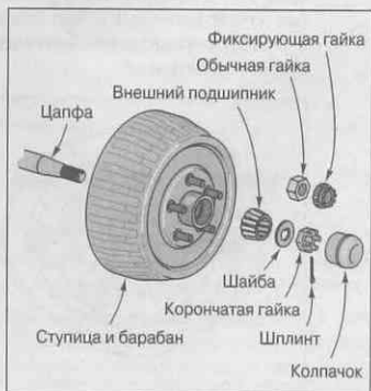
Рис. 18.4. Детали, которые необходимо снять, чтобы добраться до тормозов барабанного типа
