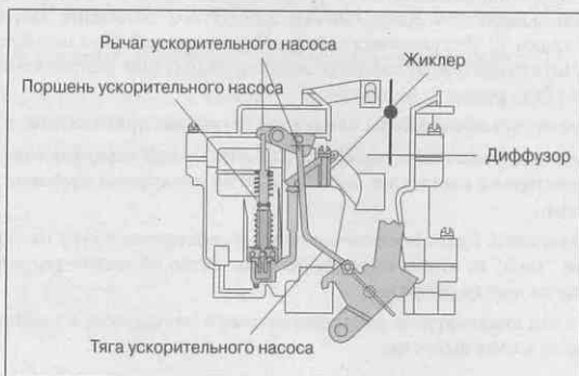
Рис. 13.10. Схема ускорительного насоса
