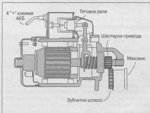
Рис. 5.4. Конструкция стартера
