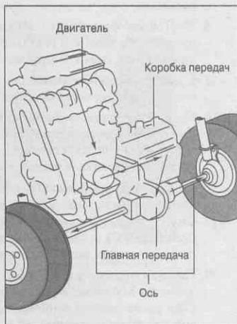
Рис. 9.2. Передача крутящего момента по ведущему мосту в блоке с коробкой передач
