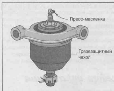
Рис. 16.3. Пресс-масленка на шаровой опоре
