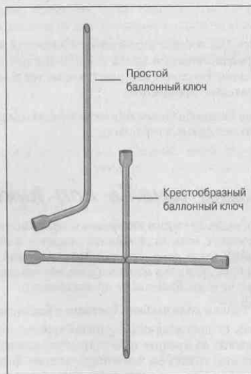
Рис. 2.20. Баллонные ключи необходимы при смене колес
