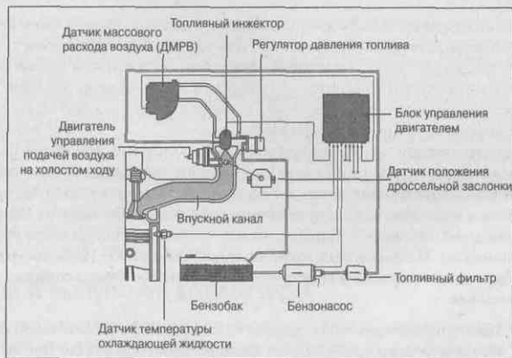
Рис. 6.9. Схема работы моноинжекторной системы впрыска.
