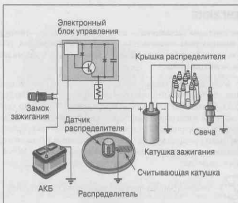
Рис. 5.9. Схема электронной системы зажигания
