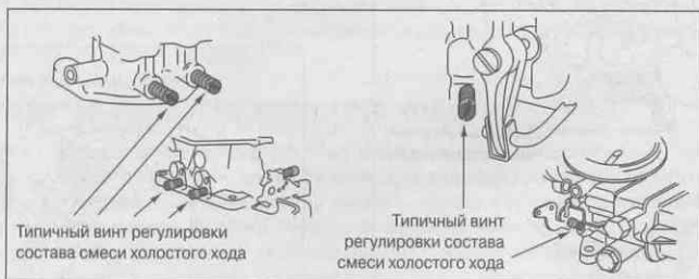
Рис. 13.13. Винты регулировки холостого хода
