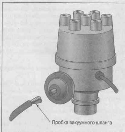
Рис. 12.50. Отключение шланга вакуумного регулятора
