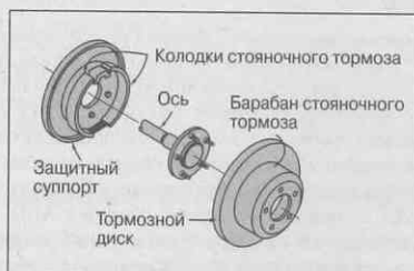
Рис. 10.11. Стояночный тормоз на заднем дисковом тормозе
