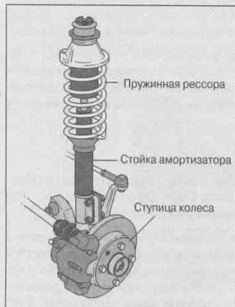
Рис. 11.4. Обычная подвеска стоечного типа
