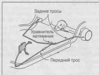
Рис. 10.9. Интегрированная система стояночного тормоза
