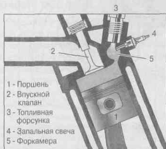
Рис. 7.2. Запальные свечи нагревают воздух в цилиндрах
