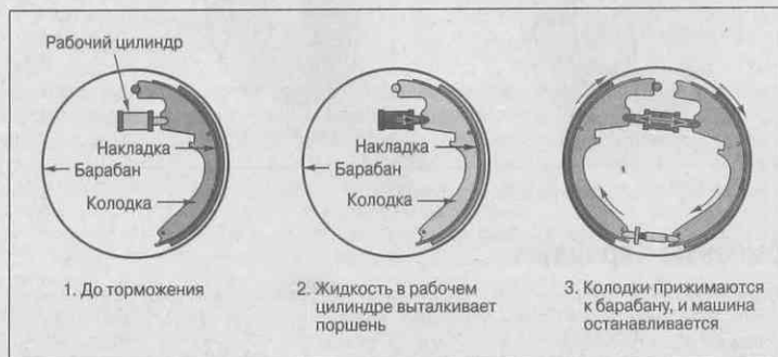
Рис. 10.7. Барабанный тормоз в действии
