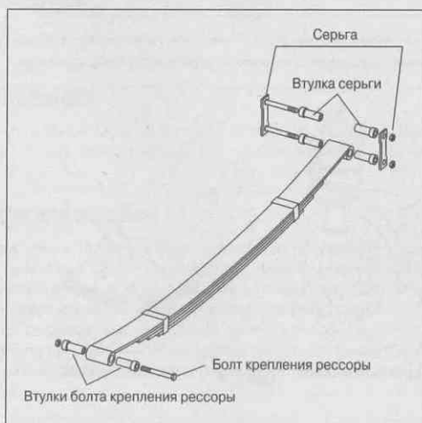
Рис. 11.8. Листовая рессора сгибается не ломаясь, так как ее листы могут скользить относительно друг друга
