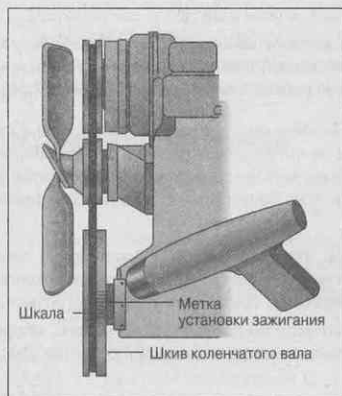
Рис. 12.48. Установочные метки на шкиве коленчатого вала
