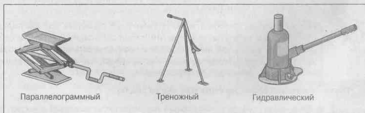
Рис. 1.1. В зависимости от вида домкрата вам придется крутить или качать
