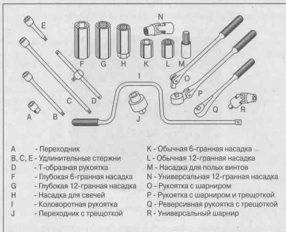
Рис. 2.9. Части торцового ключа: переходники, ручки с трещоткой и удлинители
