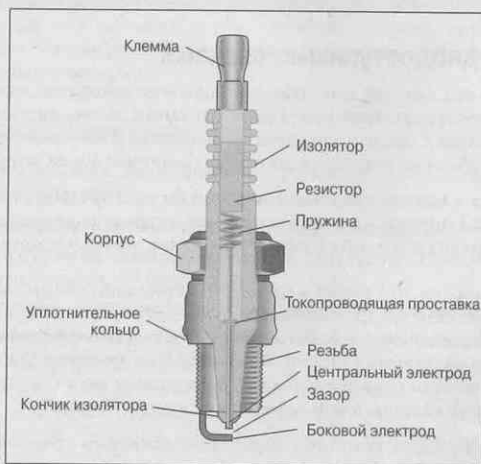
Рис. 12.10. Конструкция свечи зажигания
