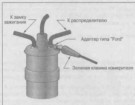
Рис. 12.44. Подключение измерителя на некоторых моделях автомобилей Ford
