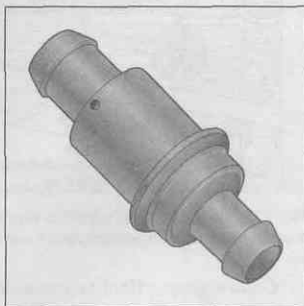
Рис. 13.5. Клапан ПВК
