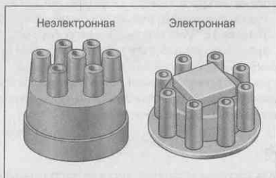
Рис. 5.13. Крышки электронного и неэлектронного распределителей
