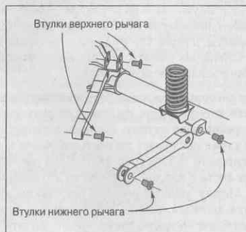
Рис. 16.8. Задние рессоры оснащены резиновыми втулками
