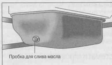
Рис. 15.6. Пробка для слива масла расположена в нижней части картера двигателя
