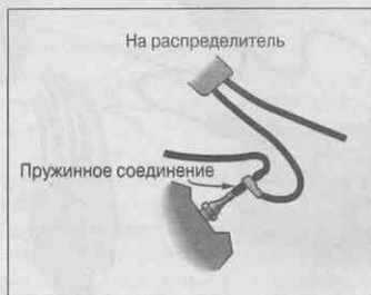
Рис. 12.46. Использование пружинного соединителя для подключения к свече № 1
