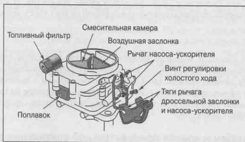
Рис. 21.1. Типичный карбюратор
