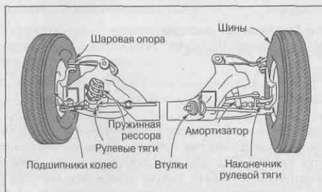
Рис. 16.1. Места возникновения трения при движении автомобиля
