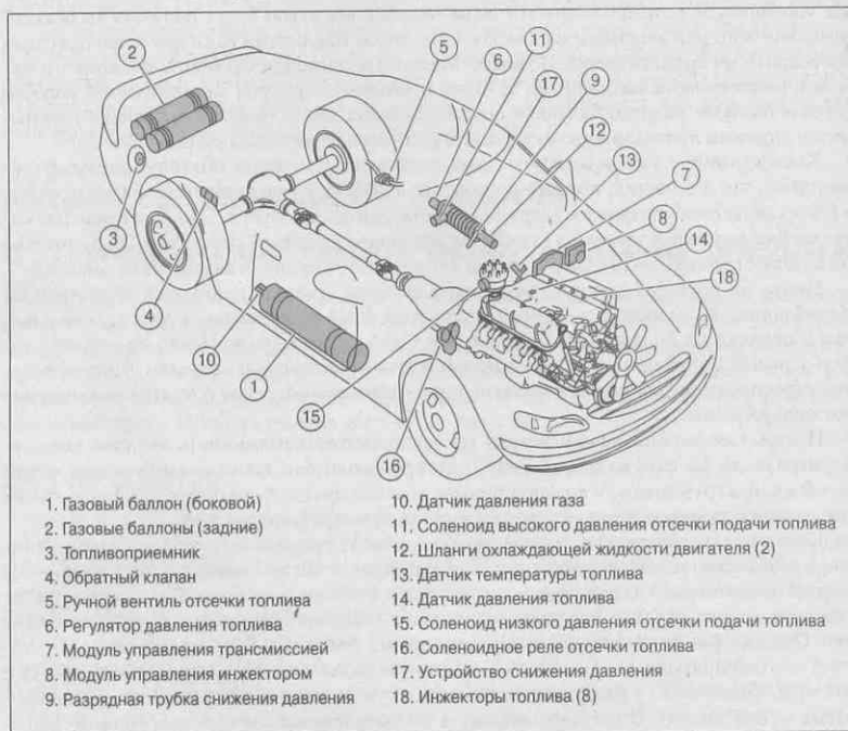
Рис. 7.11. Схема автомобиля, работающего на природном газе
