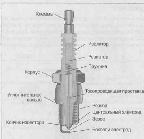
Рис. 5.12. Свеча в разрезе
