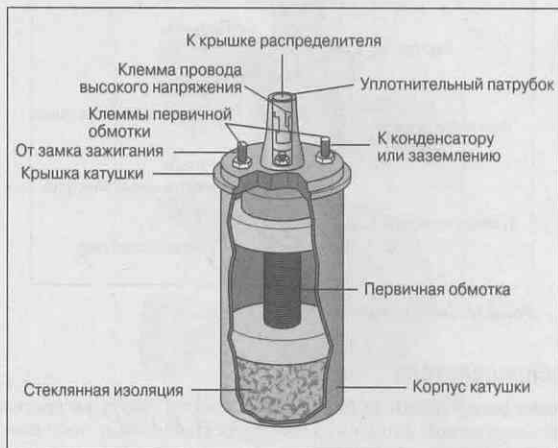
Рис. 5.11. Катушка зажигания в разрезе
