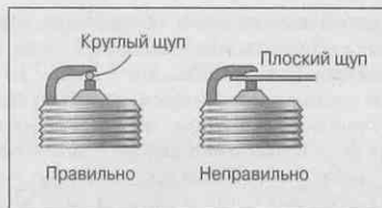
Рис. 12.11. Вот почему не следует пользоваться плоскими щупами при измерении зазора на старых свечах
