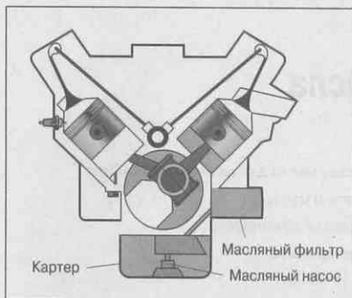
Рис. 15.1. В процессе циркуляции по двигателю масло фильтруется
