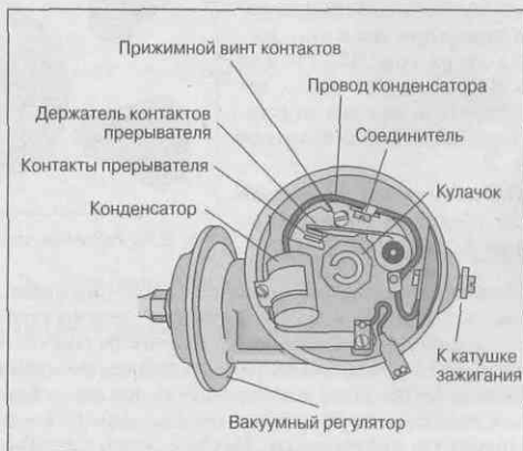
Рис. 12.15. Конструкция механического распределителя зажигания
