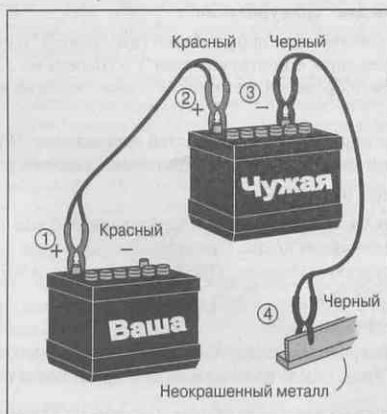
Рис. 21.3. Подключайте провода в правильном порядке
