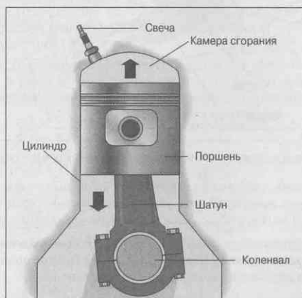
Рис. 6.12. Цилиндр в разрезе
