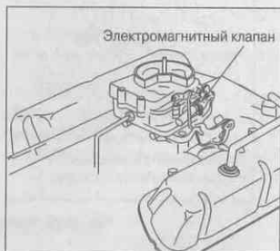
Рис. 13.12. Электромагнитный клапан карбюратора
