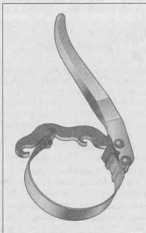
Рис. 15.5. Ключ для съема фильтра
