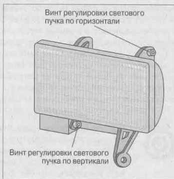
Рис. 12.54. Регулировочные винты галогенной фары
