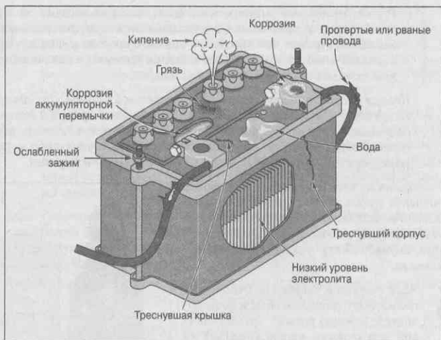
Рис. 3.4. Части АКБ, на которые надо обращать внимание во время проверки
