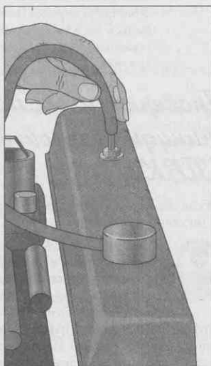
Рис. 13.7. Клапан ПВК в крышке газораспределительного механизма со снятым шлангом
