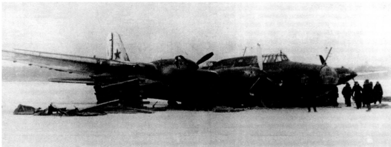
Подъем аварийного Пе-8 №42028 при помощи подручных средств для установки на шасси
