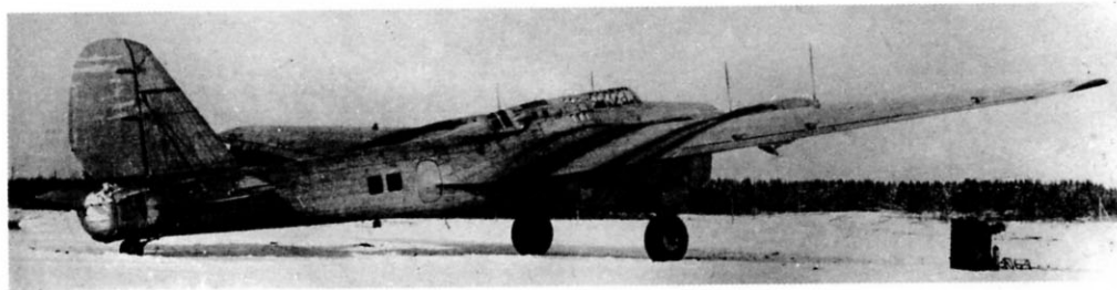
Первый опытный АНТ-42 после установки пятого двигателя М-100 (АЦН) в фюзеляже
