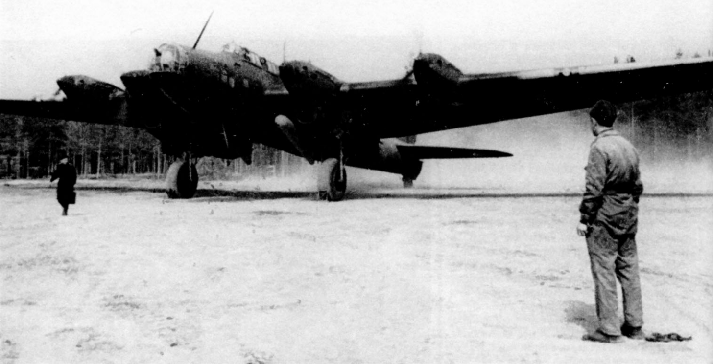
На старт выруливает Пе-8 с подвешенными выливными авиаприборами ВАП-1000
