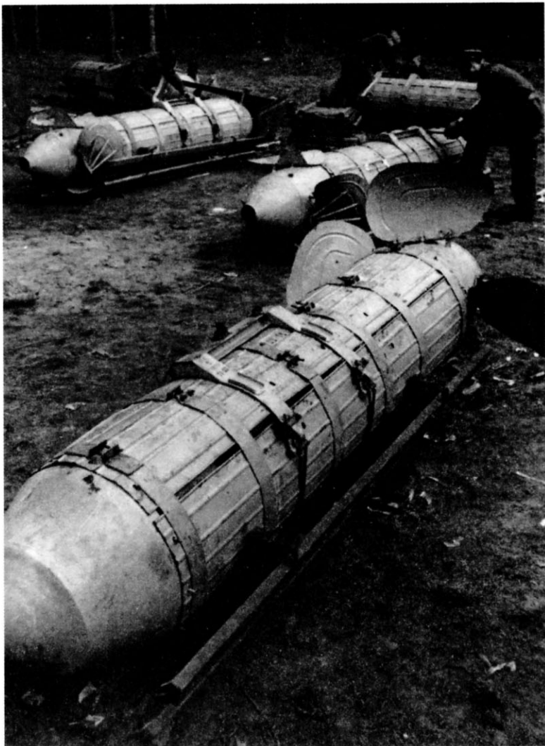
Подготовка ротативно- рассеивающих авиабомб РРАБ-1 к снаряжению
