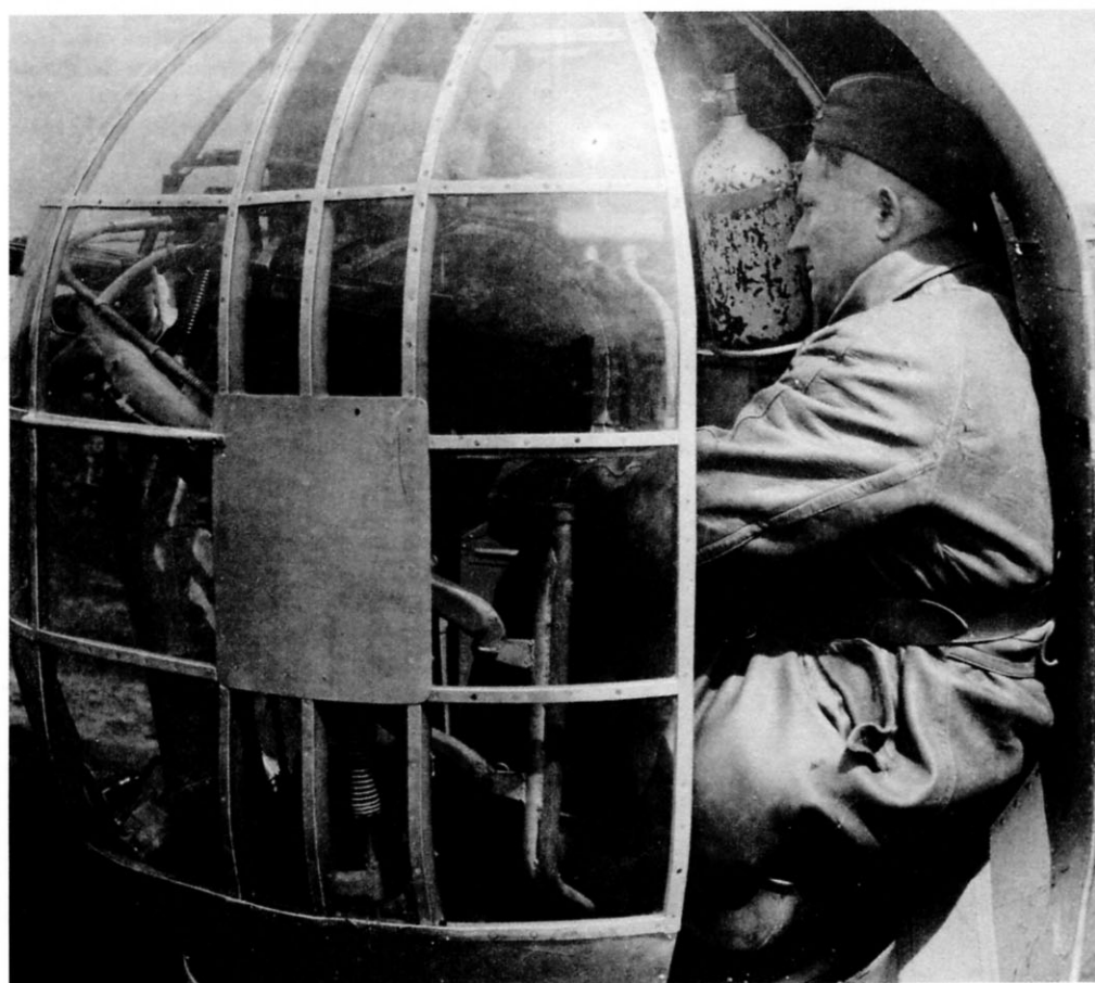
Общий вид кормовой оборонительной установки, повернутой в крайнее правое положение, при котором возможно было покидание самолета с парашютом
