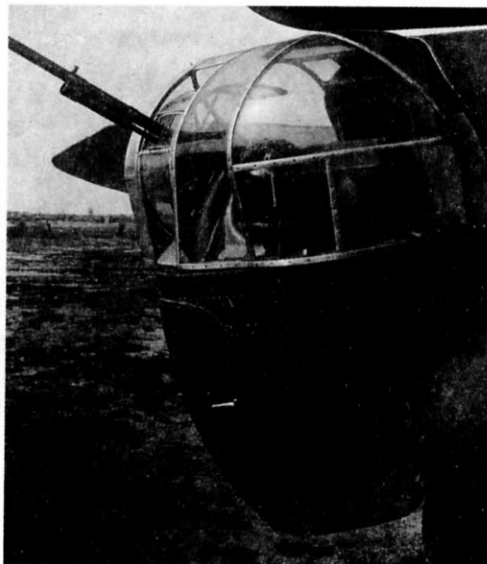
Кормовая установка ТАТ с пушкой ШВАК на ТБ-7 №4218. Ранее самолет был оборудован кормовой оборонительной турелью 2Т-215 с пулеметом ШКАС
