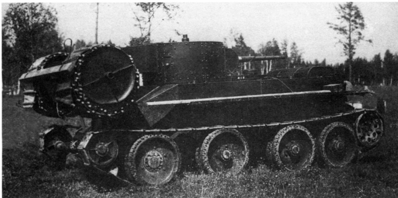
Танк БТ-5 с устройством для укладки и сброса деревянной фашины. 1935 год (АСКМ).
