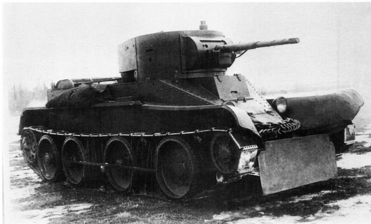
Танк БТ-7М во время испытания плуга-канавокопателя КВ. 1940 год (АСКМ).
