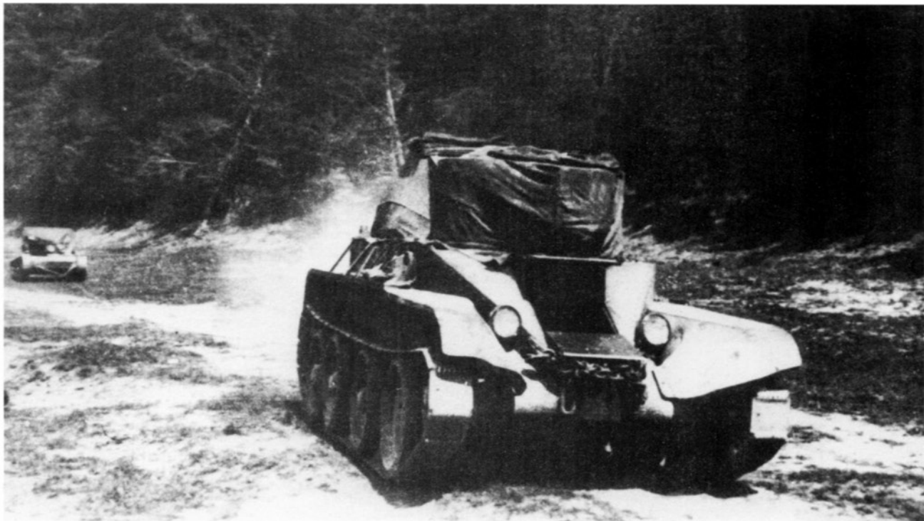
Танк подводной буксировки БТ-5 ПБ во время испытаний. 1935 год (АСКМ).
