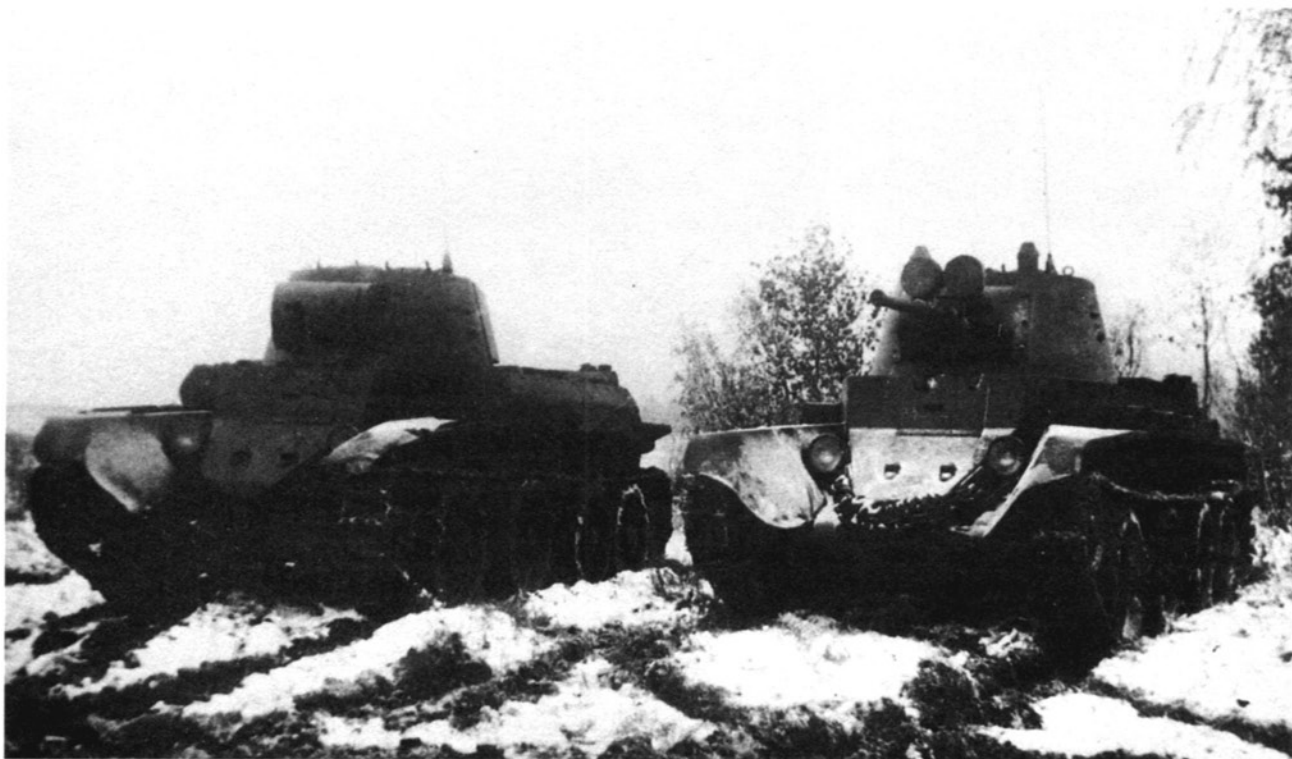
Телемеханическая группа танков А-7 — справа танк управления, слева телетанк. Зима 1940 года (АСКМ).
