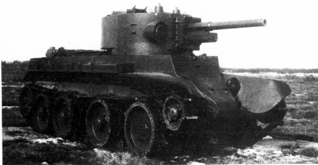
Испытания танка БТ-7А с установленной в башне 76-мм пушкой Ф-32 (АСКМ).
