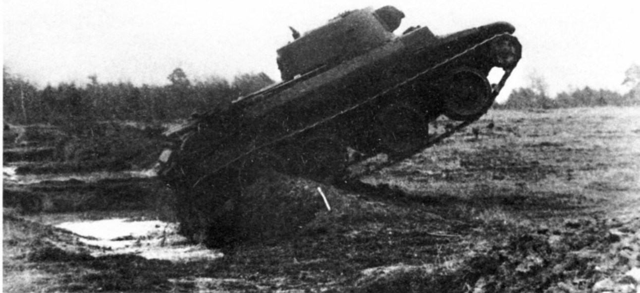
Телетанк телемеханической группы А-7 преодолевает препятствия в ходе испытаний. Машина движется без экипажа. 1940 год (АСКМ).
