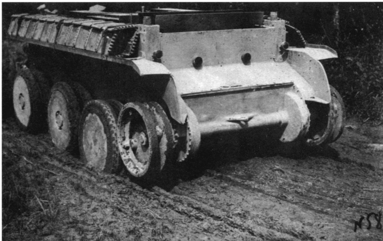
Танк Кристи преодолевает грязный проселок на колесном ходу. НИИТ полигон, лето 1932 года (АСКМ).
