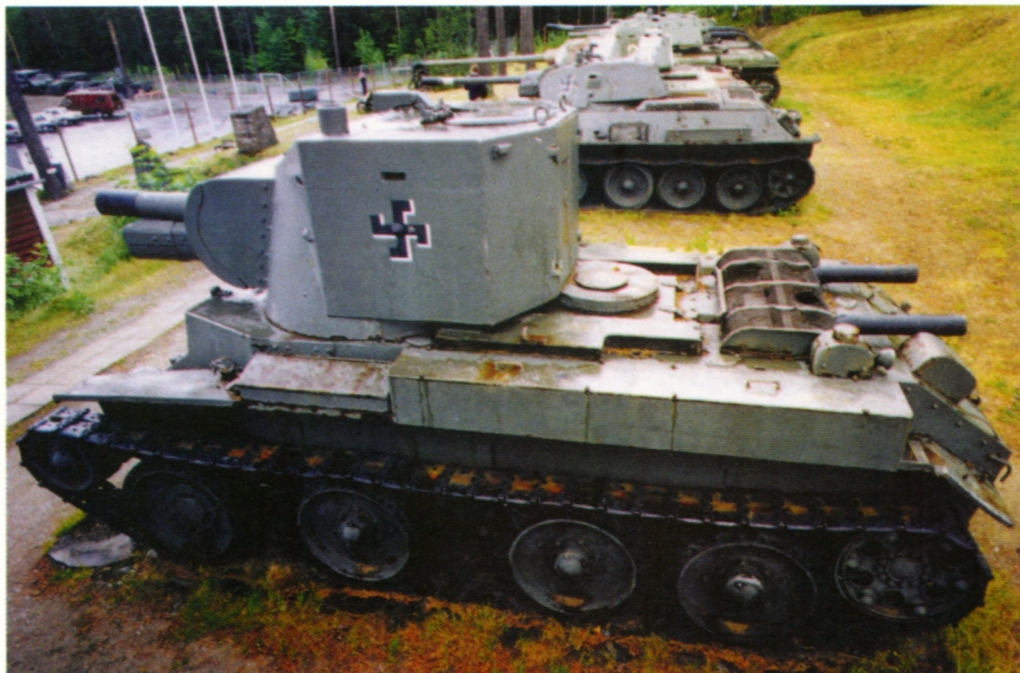
Танк БТ-7, переделанный финнами в самоходную установку 114-мм гаубицы (финское обозначение БТ-42), на экспозиции музея бронетанковой техники в местечке Парола.
