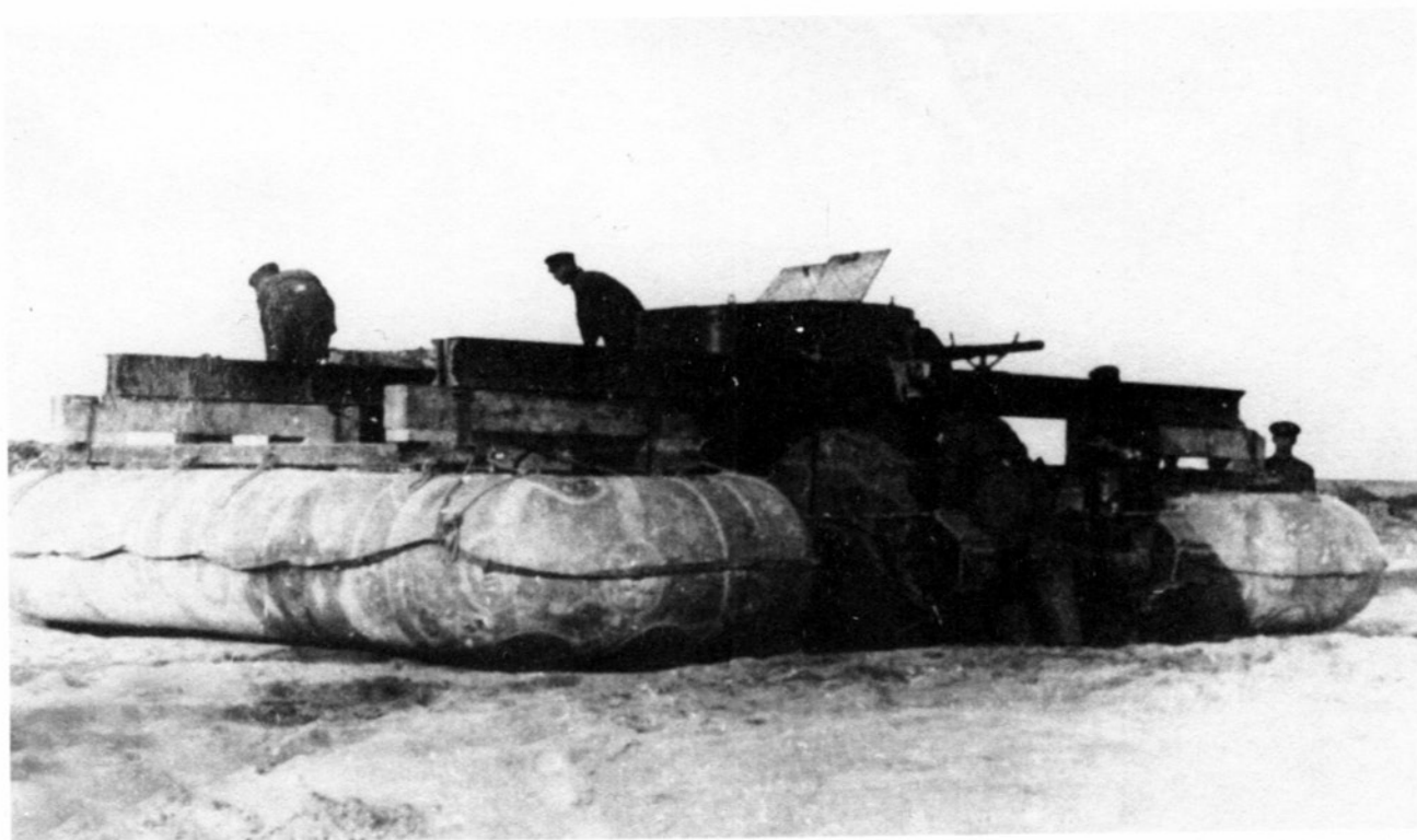
БТ-5 с плавсредством конструкции Кравцова преодолевает Амурский залив. 1935 год (РГАКФД).
