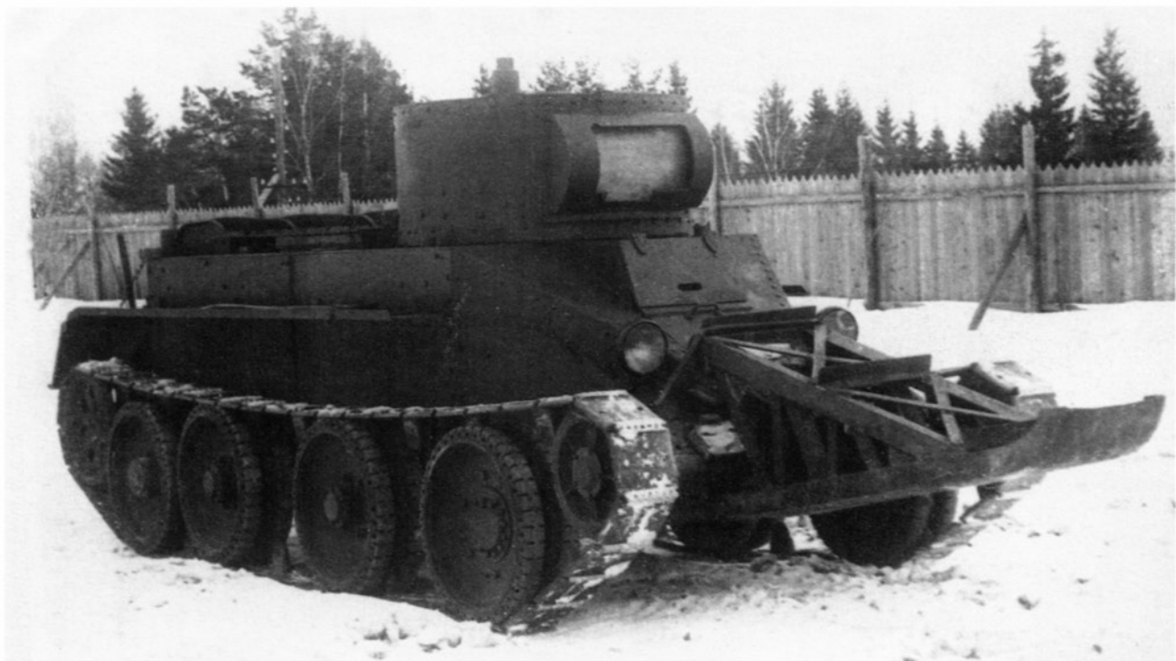
Танк БТ-5 с приспособлением «нос» для преодоления рвов. 1934 год (АСКМ).
