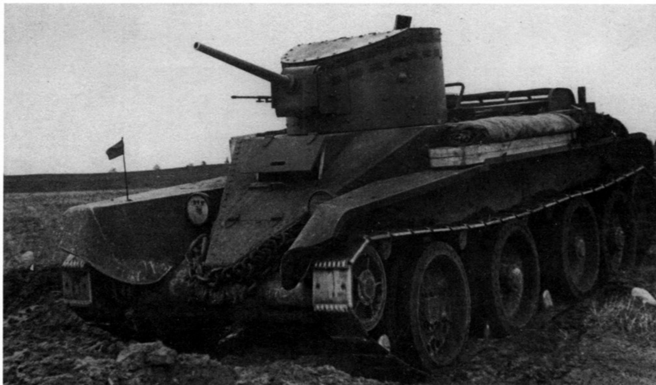
Танк БТ-2 со смешанным пушечно-пулеметным вооружением. Лето 1935 года. На машине установлены передние крылья по типу БТ-5 (ЦМВС).
