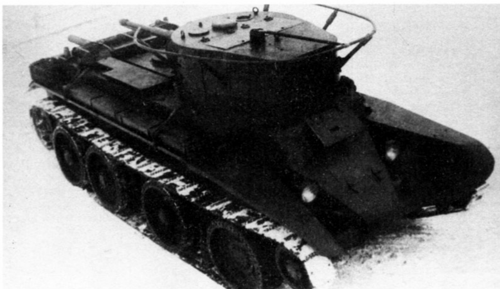
Общий вид радийного танка БТ-7 выпуска 1935 года. Хорошо видна конструкция поручневой антенны (РГАЭ).
