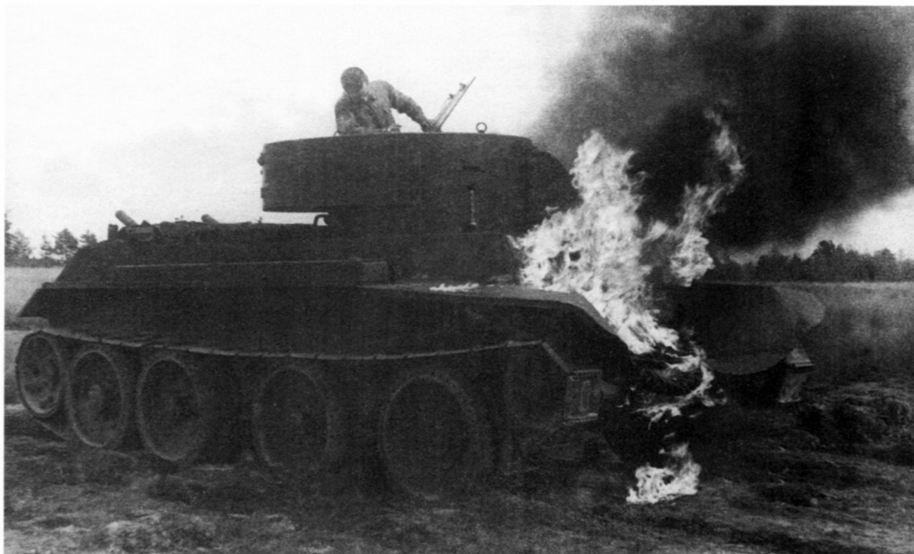
Испытания танка БТ-7 на герметичность от проникновения горючих жидкостей. 1938 год (АСКМ).
