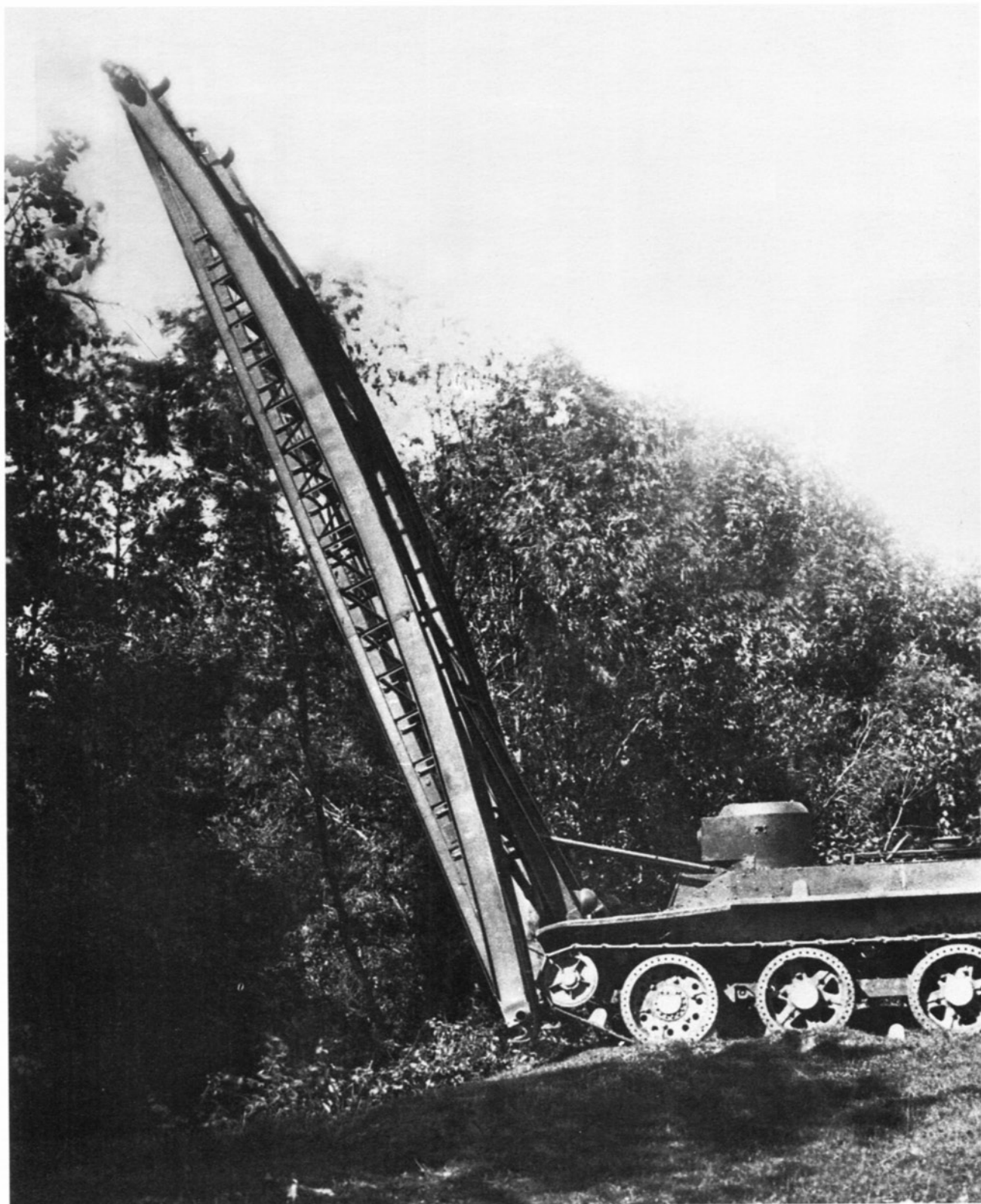
Наводка металлического моста танком СБТ на базе БТ-2. 1937 год (АСКМ).
