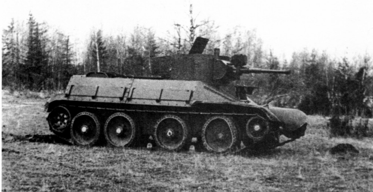
Испытания усовершенствованного танка БТ-5-ИС. 1939 год. Хорошо видна дополнительная бронировка корпуса, передний опорный каток деформирован во время испытания машины обстрелом (АСКМ).
