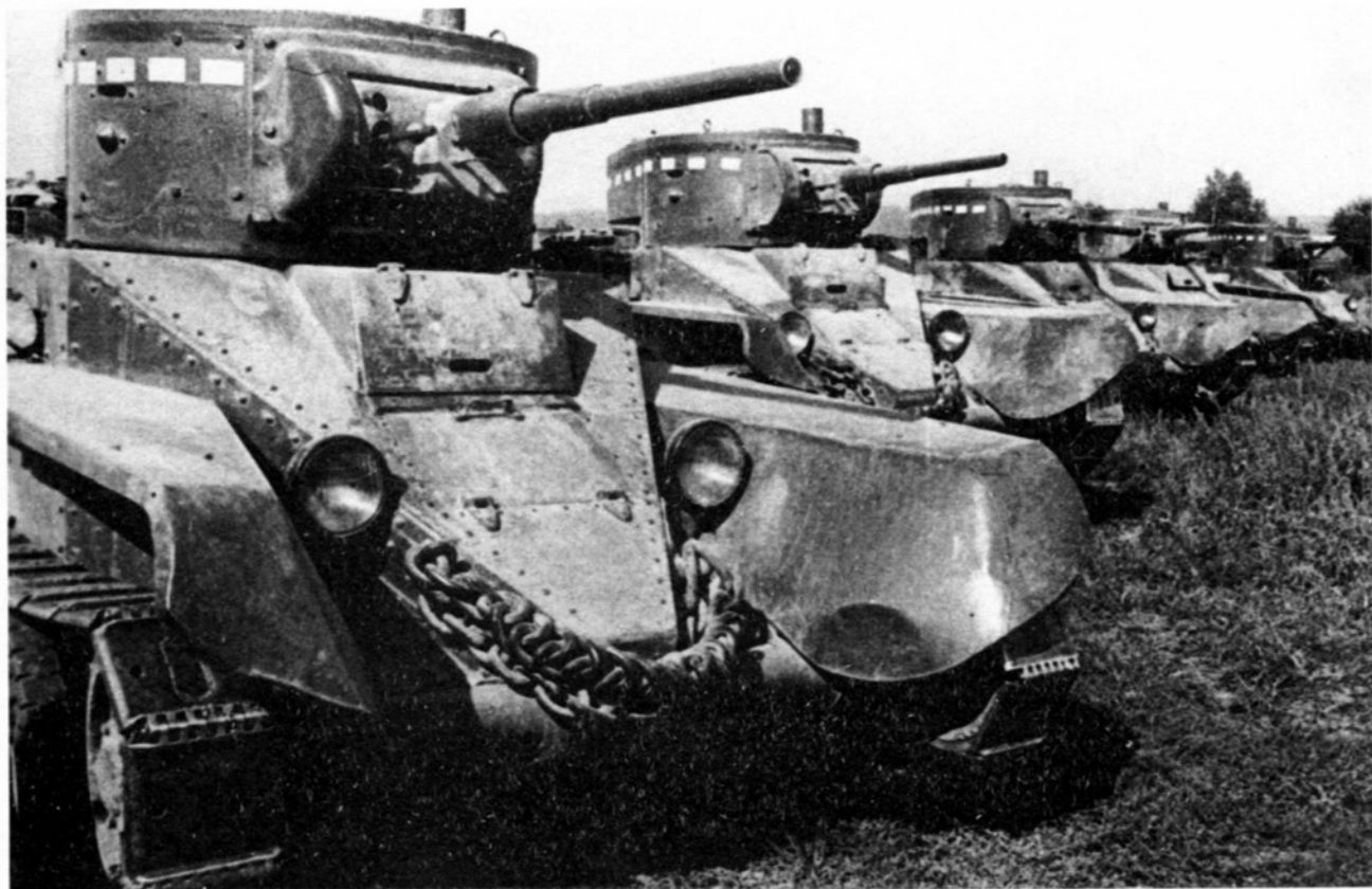
Танки БТ-5 перед началом маневров. Лето 1935 года. На фото хорошо видно крепление буксирных цепей (РГАКФД).
