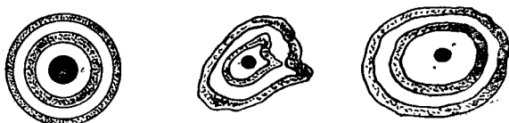
Рис. 109. Различная форма дифракционных колец в зависимости от качества объектива и регулировки телескопа.
