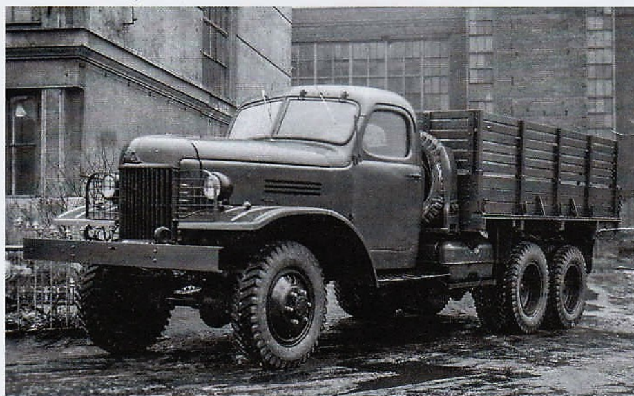
С сентября 1949 года на ЗИС-151 начали устанавливать цельнометаллическую кабину
